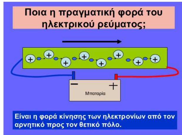
Η φορά κίνησης των ηλεκτρονίων
