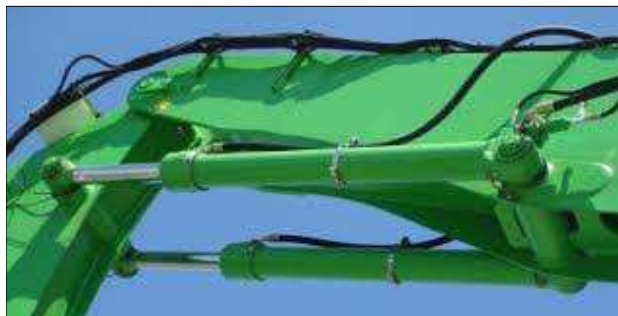
Υδραυλικοί κύλινδροι / βραχίονες σε χωματουργικό μηχάνημα
