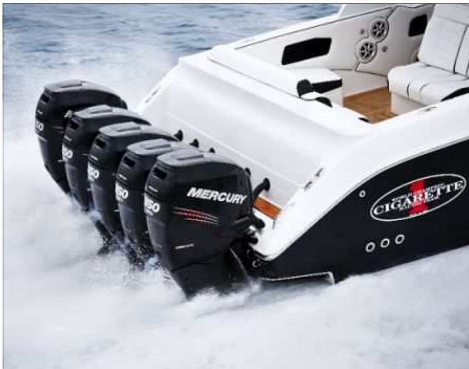
Συγκρότημα πέντε (5) σύγχρονων εξωλέμβιων μηχανών MERCURY μεγάλης ιπποδύναμης σε ταχύπλοο αγωνιστικό σκάφος (τύπου Cigarette)
