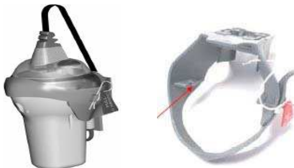
EPIRB σε αφαιρούμενο κολάρο "ασφαλούς μεταφοράς". Το βέλος δείχνει το μαγνήτη στο αφαιρούμενο κολάρο που απενεργοποιεί τον θαλάσσιο διακόπτη EPIRB που ενεργοποιούνται αυτόματα
