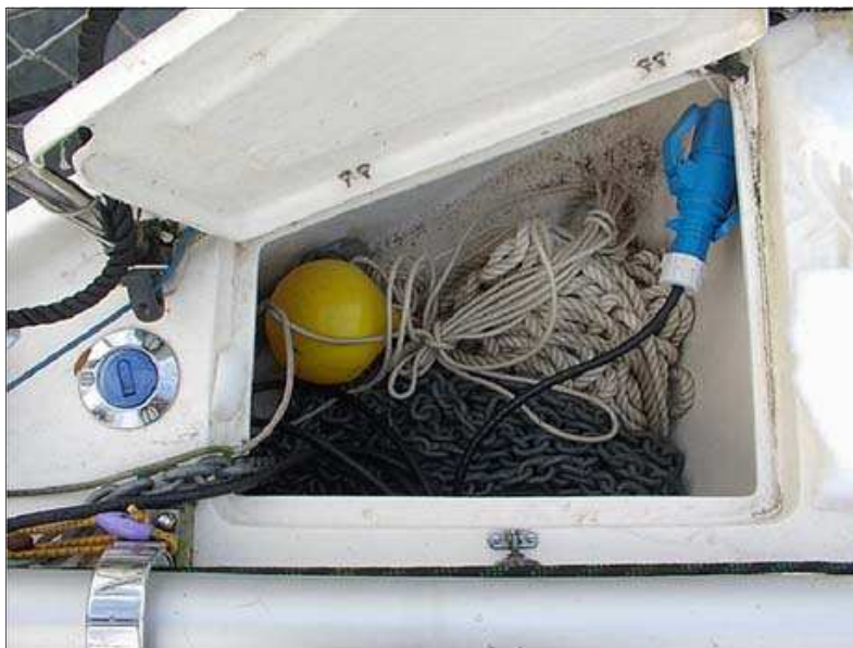
Ρευματολήπτης ρεύματος ξηράς φυλασσόμενος σε ασφαλή και προστατευμένη θέση
