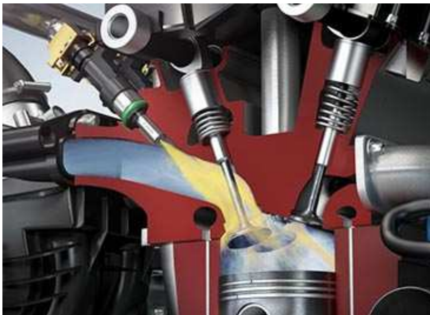
Ψεκασμός Πολλαπλών Σημείων (Port Fuel Injection ή PFI)
