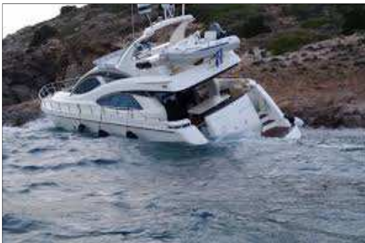
Εισροή υδάτων σε ταχύπλοο σκάφος
