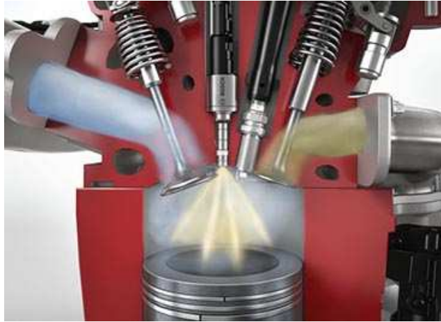
Άμεσος ψεκασμός βενζίνης (Gasoline Direct Injection)
