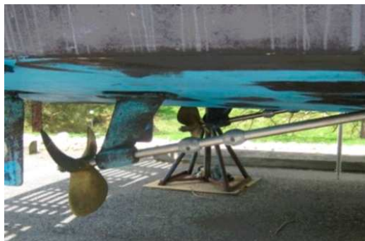
Ελικοφόρος άξονας με τα ακροπρυμναία στηρίγματα και τους τριβείς του
