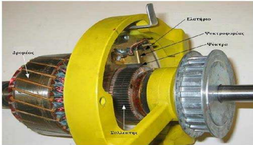
Ψύκτρες ηλεκτρικών κινητήρων
