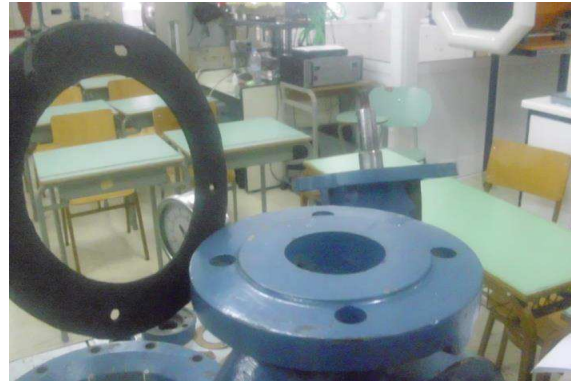
Στεγανοποίηση αντλιών με φλάντζα εξόδου και παρέμβυσμα
