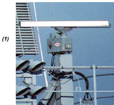
(1) Η κεραία του Ραντάρ στην οποία βρίσκονται, ο πομπός, διακόπτης εναλλαγής πομπού-δέκτη (T/R switch) και (2) ο δέκτης/μονάδα ένδειξης, οθόνη τύπου λυχνίας TV ή υγρού κρυστάλλου (LCD)
