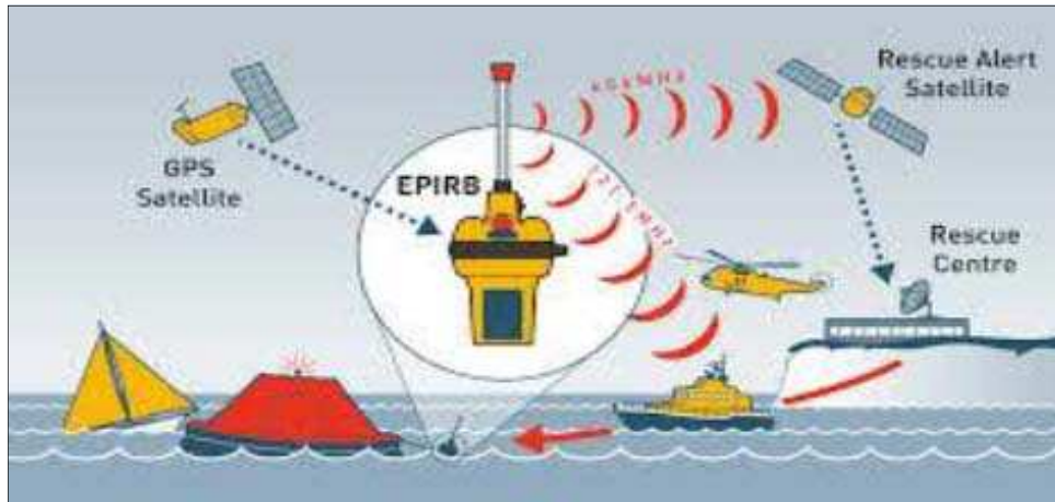
Λειτουργία συστήματος EPIRB
