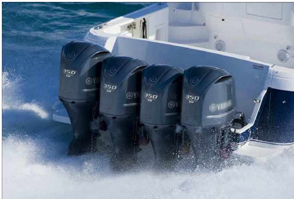
Ταχύπλοο σκάφος με τέσσερις εξωλέμβιες μηχανές τύπου YAMAHA 350 HP (ισχύς 1400 HP/αγωνιστική χρήση)
