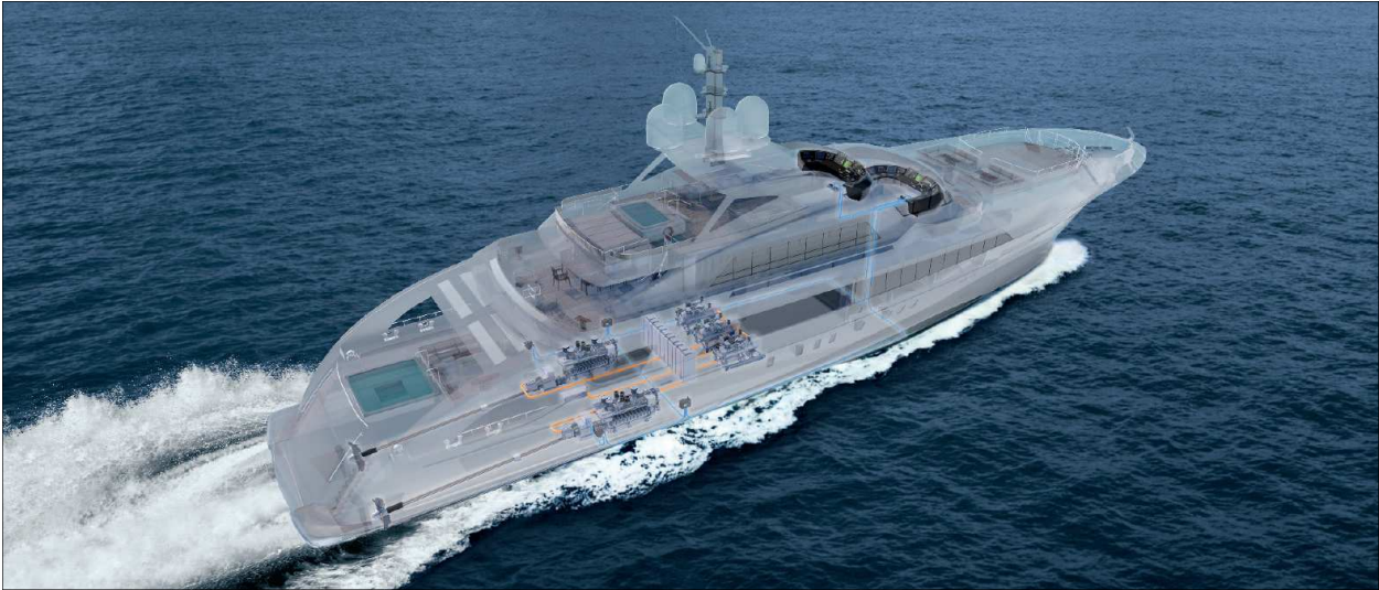
Τρισδιάστατη απεικόνιση εσωλέμβιων μηχανών σε μηχανοστάσιο ταχύπλοου σκάφους
