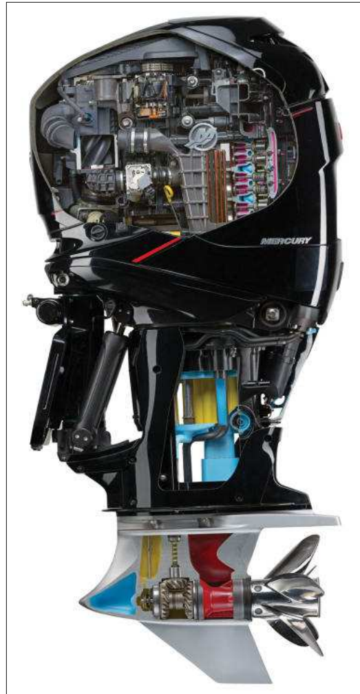
Σύγχρονες εξωλέμβιες μηχανές μεγάλης ιπποδύναμης τύπου SUZUKI 325 HP σε ταχύπλοο σκάφος και Mercury VERADO 400 HP (τελευταίας γενιάς)
