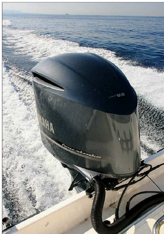
Στήριξη του κινητήρα YAMAHA F 350 σε ένα ενισχυμένο μπρακέτο
