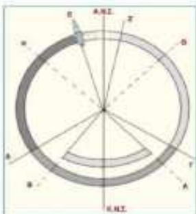
Κυκλικό διάγραμμα λειτουργίας δίχρονου βενζινοκινητήρα.
