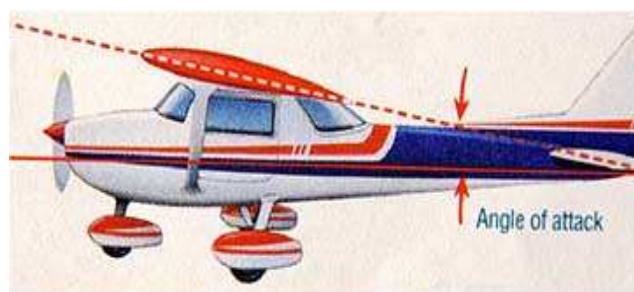
Εικόνα (2): Όταν υπάρχει «γωνία προβολής» η θετική πίεση από κάτω και η αρνητική από πάνω θα κάνουν το αεροπλάνο να σηκωθεί στον αέρα
