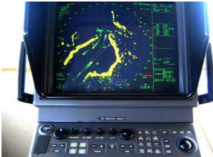
Ραντάρ με ενσωματωμένο σύστημα ARPA
