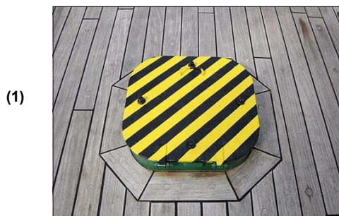
Καταπακτή στο κατάστρωμα (Ταμπούκι) (1) κλειστή (2) ανοικτή
