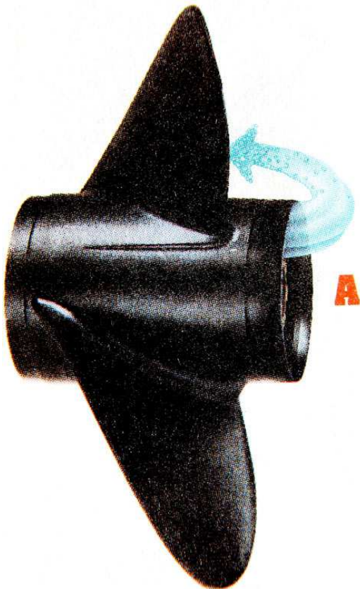
Έλικα με έξοδο κορμιά (trailing edge) με ευθύγραμμο χείλος που αφήνει μέρος των νερών να επιστρέψουν πίσω
