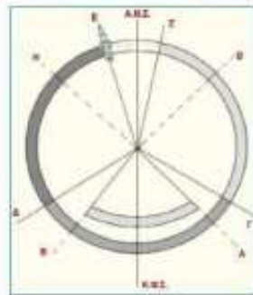
Κυκλικό διάγραμμα λειτουργίας δίχρονου βενζινοκινητήρα.
